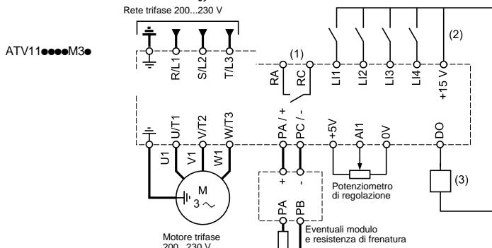
(1) Contatti del relé di difetto, per segnalare a distanza lo stato del variatore.
