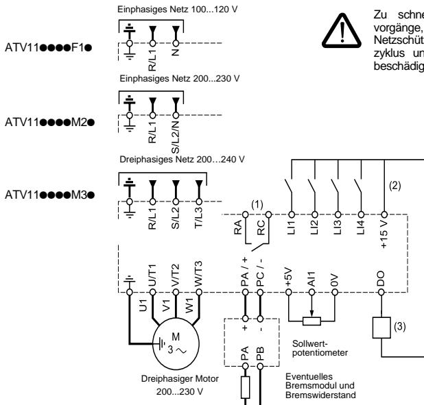
Zu schnell aufeinander folgende Einschaltvorgänge, beispielsweise bei Verwendung eines Netzschützes, sind zu vermeiden. Ein Einschaltzyklus unter 5 Minuten kann den Umrichter beschädigen.
