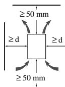
Instale el aparato en posición vertical, a  $\pm 10^\circ$ .
